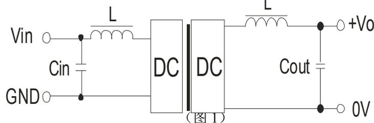
但应注意电感值的选取及“LC”滤波网络其自身的频率应与 DC/DC 频率错开，避免相互干扰。并选用合适的滤波电容。若电容太大，很可能会造成启动问题。输出电容的选取，请参考最大输出容性负载要求。
